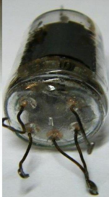
Im Bild 2 sind drei der vier Blechlaschen zu sehen die geöffnet werden müssen. Das Bild 3 zeigt den Kolbenanschluss von dem Gitter 1 der am oberen Ende entlötet wird.
